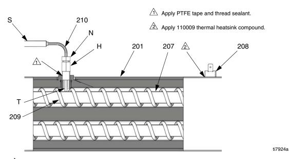
Fig. 10. Thermocouple
